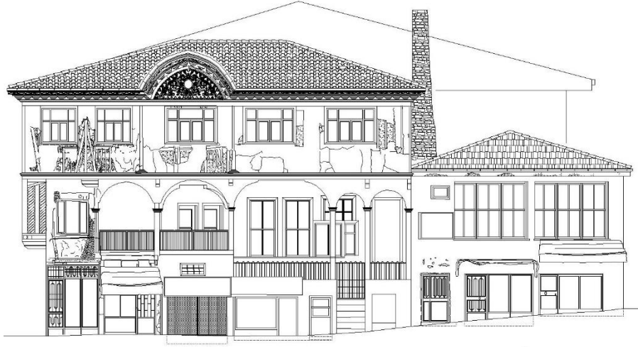
Şekil 7: Güney (Ön)- güneybatı cephesi rölöve çizimi
